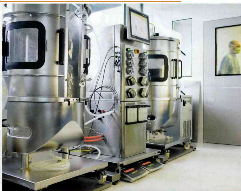
Ces deux cuves cylindriques, autour du moniteur central, sont des bioréacteurs de 200 litres. On y cultive des cellules productrices de virus modifiés utilisés dans différents essais de thérapie génique.
